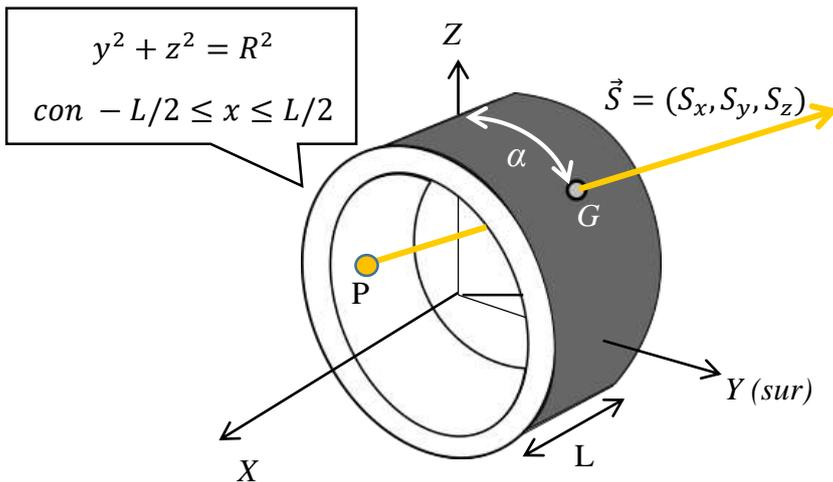
El limbo es la parte interior de un anillo de radio  $R$  y anchura  $L$  que tiene un agujero ( $G$ ) situado a un ángulo  $\alpha$  de la vertical. Un rayo de Sol entra por  $G$  e impacta en  $P'$ . Pretendemos obtener las coordenadas del punto luminoso  $P$ . Las coordenadas de  $G$  con respecto al anillo son las siguientes:
