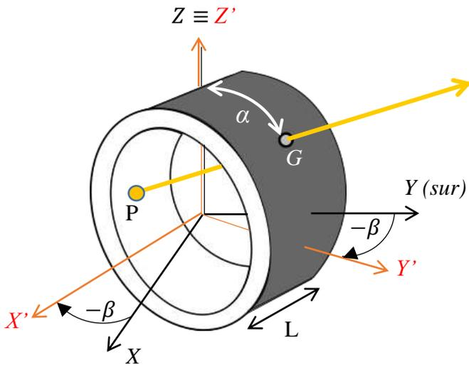
En el caso del reloj anular, el anillo, suspendido por una cuerda situada en Z, debe girar un ángulo igual al azimut para ir enfrentándose al Sol. Además, habrá que efectuar un giro adicional para que la proyección caiga sobre la línea de la fecha correspondiente. Llamemos  $\beta$  al ángulo total de giro, es decir, giramos  $\beta$  en sentido horario alrededor de Z:
